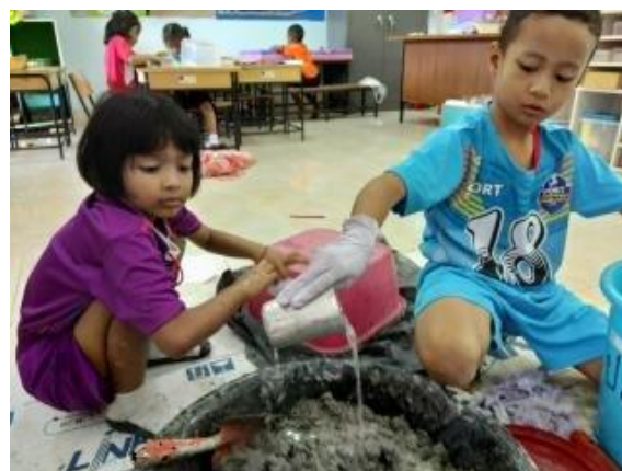
เติมปูนผสมเพิ่มอีก ๑ ถัง เติมน้ำเพื่อให้ปูนและกระดาชเกาะตัว
